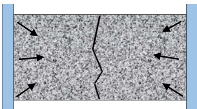
Figuur 1. Schematische weergave van scheurvorming veroorzaakt door beperkte krimp
