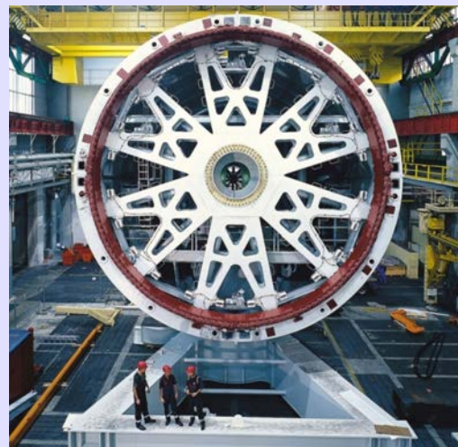
7.5 MW PM rotor (Enercon)
