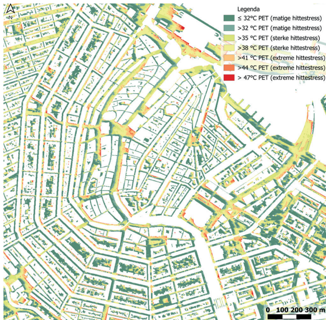
Figuur 2. Referentie PET kaart van Amsterdam. Hier is windsnelheid berekend via Large-Eddy Simulations (LES).
