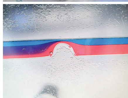
Foliechips uit de snijplotter. Focused flow druppelchip (2018), Swirl mixer met vorming nanogoud (2018), Model vaatvernauwing (atherosclerose) op chip (2019) met turbulentie, zichtbaar via nanogoud (boven) en kleurstoffen (onder; turbulentie is paars) in PlexiLoC, ca 40x vergroot.
